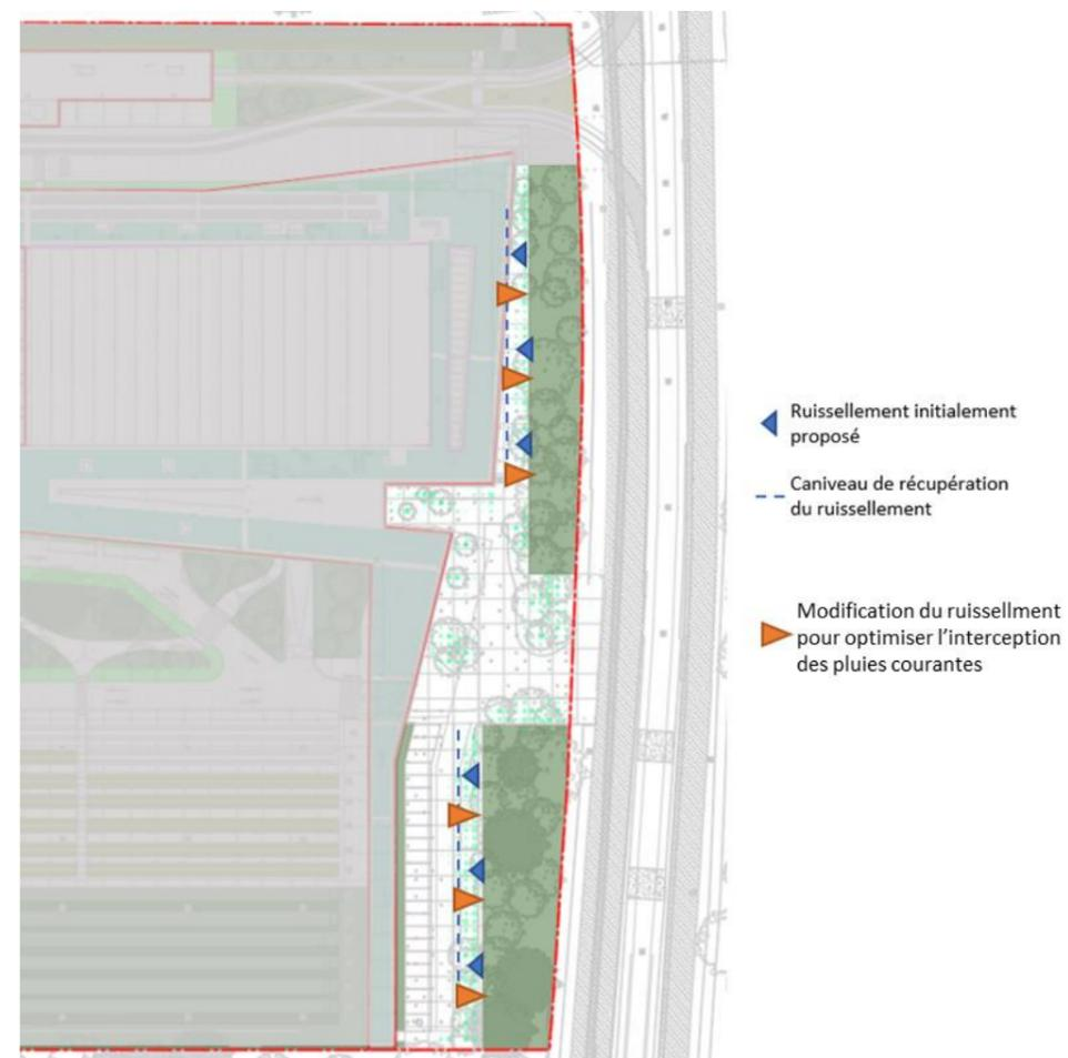
**Figure 48 : Orientation des eaux de ruissellement sur l'espace parvis stationnement avant – Projet modifié, source : AIA**
